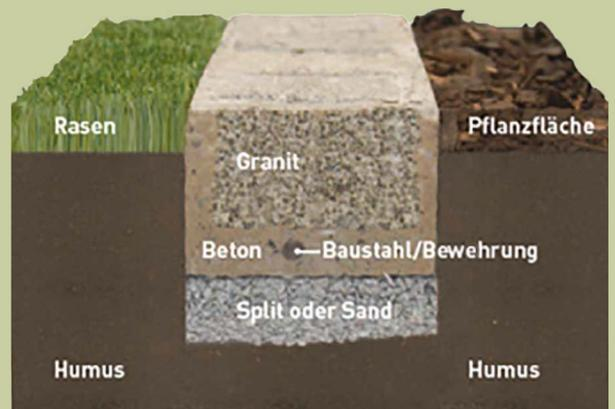
Gesetztes modagard Granit-Fertigelement im Querschnitt
