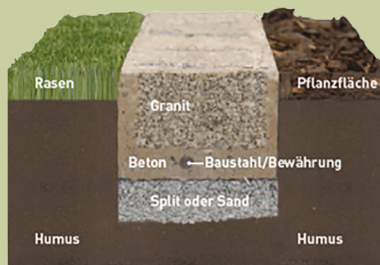
Gesetztes modagard Granit-Fertigelement im Querschnitt
